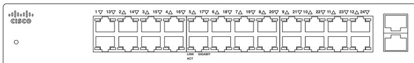
**Puertos Ethernet RJ-45** : utilice estos puertos para conectar dispositivos de red como equipos, impresoras y puntos de acceso al switch. Los puertos Ethernet (802.3) de detección automática se utilizan para comunicaciones de redes por cable. Cada puerto Ethernet soporta velocidades de 10 Mbps, 100 Mbps o 1000 Mbps.
