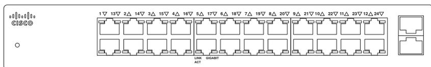
**Porte Ethernet RJ-45:** utilizzare queste porte per collegare i dispositivi di rete, come i computer, le stampanti e i punti di accesso, allo switch. Le porte con rilevamento automatico Ethernet (802.3) vengono utilizzate per le comunicazioni di rete cablate. Ogni porta Ethernet supporta velocità di rete pari a 10 Mbps, 100 Mbps o 1000 Mbps.
