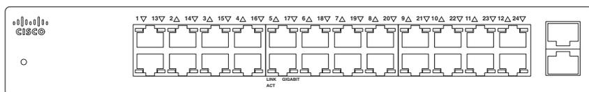
**Ports Ethernet RJ-45 :** ces ports permettent de relier au commutateur les appareils de réseautique, tels que les ordinateurs, les imprimantes et les points d'accès. Les ports Ethernet (802.3) de détection automatique sont utilisés pour les communications réseau. Chaque port Ethernet prend en charge les vitesses du réseau de 10 Mbits/s, de 100 Mbits/s ou de 1 000 Mbits/s.
