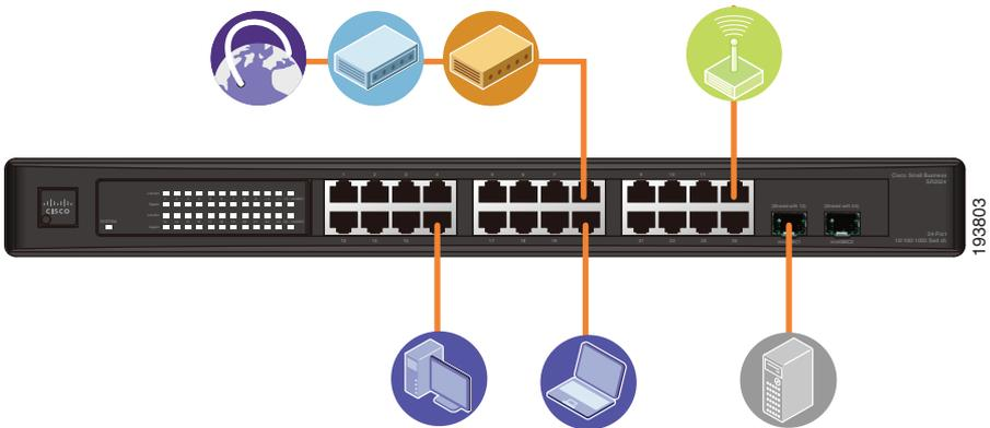
Pour connecter le commutateur non géré montable en rack au réseau :
