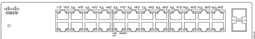
**RJ-45-Ethernet-Ports** – Verwenden Sie diese Ports, um Netzwerkgeräte wie Computer, Drucker und Access Points an den Switch anzuschließen. Die Autosensing-Ethernet-802.3-Ports werden für die drahtgebundene Netzwerkkommunikation verwendet. Jeder Ethernet-Port unterstützt Netzwerkgeschwindigkeiten von 10 MBit/s, 100 MBit/s oder 1000 MBit/s.
